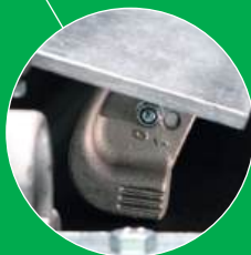
Slijtindicatoren op voetjes i.p.v. hoofdframe
